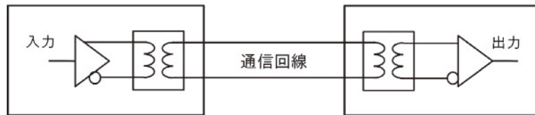
通信回線はパルストランスにより絶縁されます。
